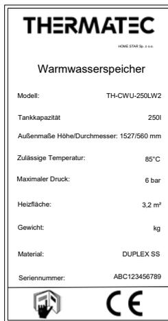
Das Typenschild wurde am Gehäuse des Tanks angebracht.
