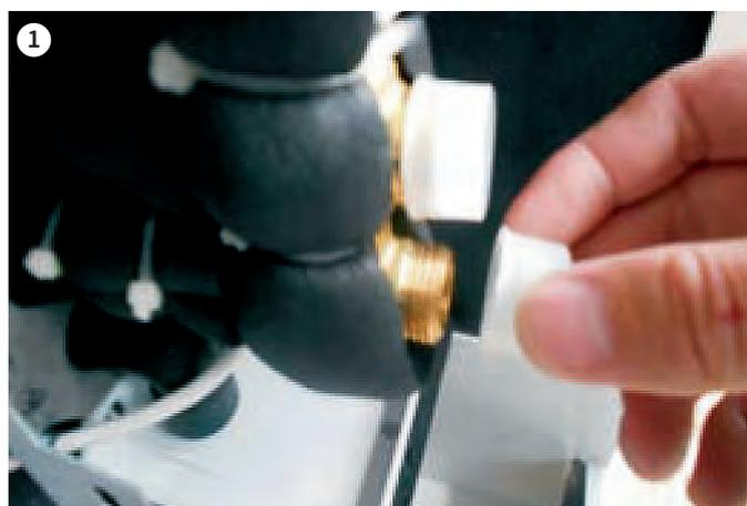
*Entfernen Sie die Dichtabdeckung.*
