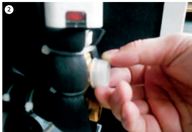
Zdejmij pokrywę uszczelniającą.
